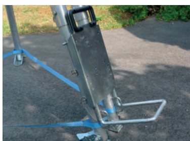
Base di fissaggio per l'argano. Fixation plate easy to set up.
